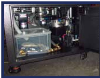
★新設計ポリッシュポンプモーター&ギアボックス
